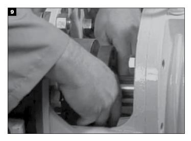
Den Gleitring in den Flansch einsetzen und den Flansch oben an der Dichtraum-Stirnfläche befestigen.
