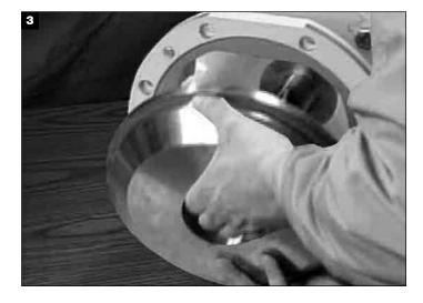
Das Dichtungsgehäuse aus der Anlage ausbauen.
